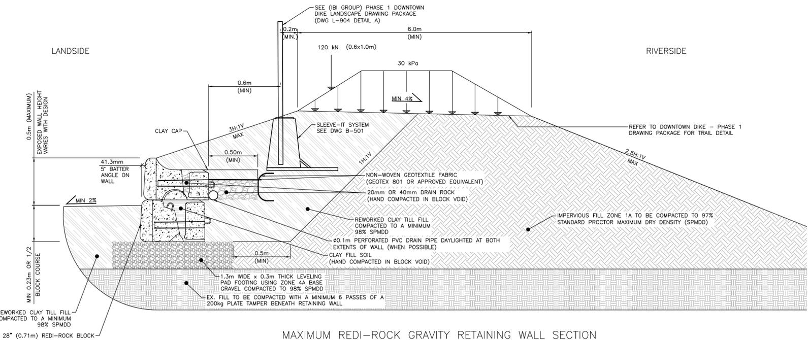
MAXIMUM REDI-ROCK GRAVITY RETAINING WALL SECTION
