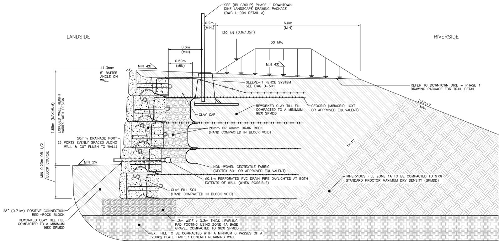
MAXIMUM REDI-ROCK GEOGRID REINFORCED RETAINING WALL SECTION
